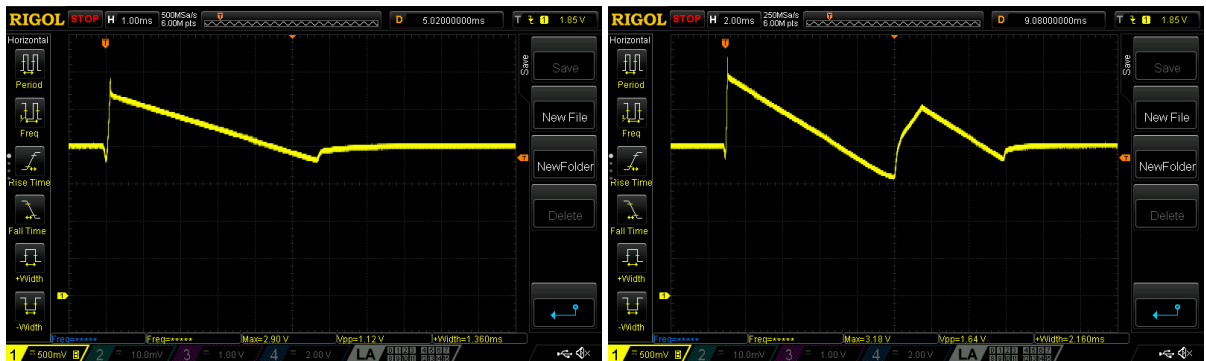
Abbildung 3.14: Ausschaltvorgang bei 5A für Kabeldemonstrator 3. Abbildung 3.15: Ausschaltvorgang bei 8A für Kabeldemonstrator 3.
