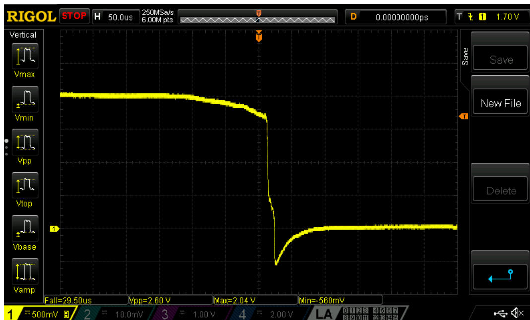
Abbildung 5.3: Ausschaltvorgang am HMP 4040 für Kabeldemonstrator 3 bei 8A mit elektronischer Last, Zeitbasis: 50\mu\text{s}/\text{DIV} .
