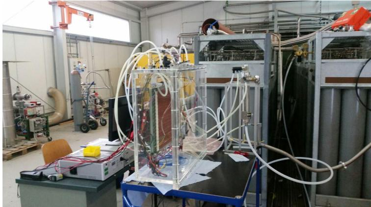
**Abb. 4.5.:** Der Aufbau für die Heliummessung in der 5-Grad-Halle des KPH. Links auf dem Tisch sind die Labornetzteile sowie der angeschlossene Computer. Mittig die stehende Box, rechts davon die zwei Rotameter. Rechts ist zu sehen wie ein Gasschlauch am Heliumvorrat, welche die Flaschen im Hintergrund sind, angeschlossen ist.
