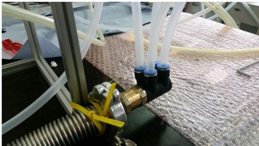
Abb. A.61.: Zusammenführung des Rückflusses der Heliumleitung.
