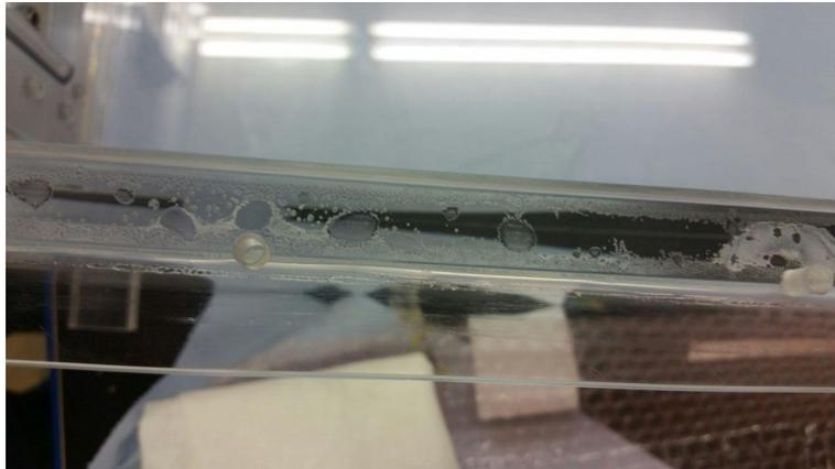
**Abb. 5.5.:** Box von Oben. Mittig zu sehen sind Lunker zwischen Wand und Kragen. Oben im Bild ist der Innenraum der Box und unten im Bild, getrennt durch die Wand der Box, der Außenraum. Zusätzlich sieht man nochmal, wie die Bohrungen auf die Wand der Box treffen, wie in Kapitel 5.1.3 Beschrieben.
