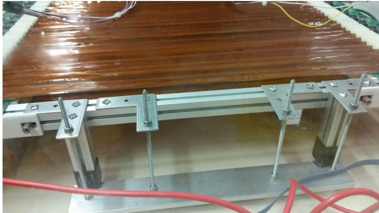
**Abb. 4.2.:** Befestigung am Prototypen. Zu sehen sind die vier M3 Gewindestangen, eine Aluminiumschiene und die zwei Abstandshalter mit schwarzem Gummiüberzug zum Schutze vor Kratzern.
