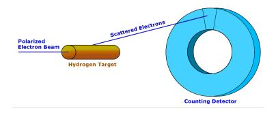
Beam :  $E_{\rm beam} = 155 \, {\rm MeV}, \quad I_{\rm beam} = 150 \, \mu {\rm A} = 10^{15} \, {\rm e}^-/s,$
